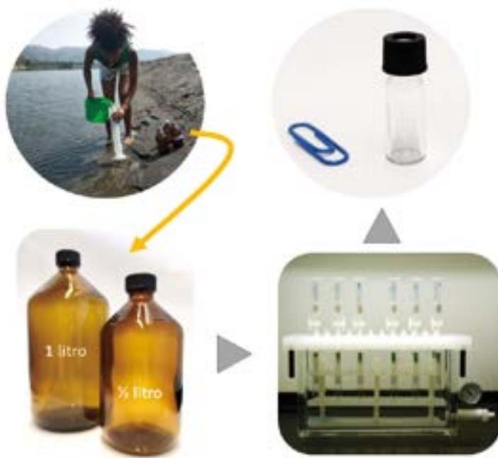
**Figura 1.** El proceso inicial para el análisis de contaminantes en agua implica tomar una cantidad grande de muestra; luego, con ayuda de técnicas como la extracción en fase sólida (esquina inferior derecha, imagen de Wikimedia Commons) se logra concentrar las sustancias de interés en un frasco pequeño denominado vial (esquina superior derecha) para su análisis posterior con instrumentos dedicados.
