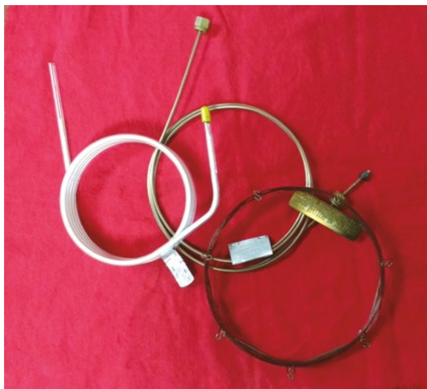
Figura 1. Evolución de las columnas para cromatografía de gases. De izquierda a derecha: columna empacada de vidrio (fabricada en la PUCE), columna empacada Megabore (comercial, cuerpo metálico), columna capilar (comercial, de uso actual).
